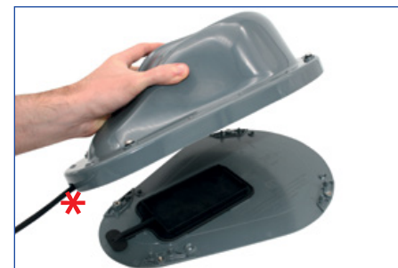
Bild 4: Setzen Sie die Outdoor Unit wieder auf die Montageplatte. Bitte halten Sie dabei das Kabel* fest, damit es nicht aus der Führungsrille rutscht.
