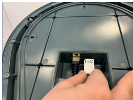
Bild 1: Legen Sie die SIM Karte mit dem goldenen Chip in Richtung Gehäuseoberseite in den Kartenleser ein. Achten Sie darauf, die Karte mit der abgeschrägten Ecke nach vorne in den Kartenleser einzuführen.
