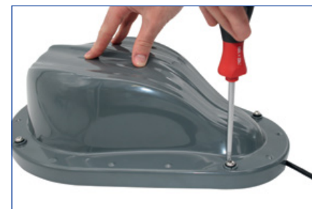
Bild 5: Drücken Sie die Outdoor Unit auf die Montageplatte herunter und ziehen die vier Schrauben mit einem Handschraubendreher wieder fest. Bitte beachten Sie dabei das maximale Anzugsdrehmoment von 1 NM!
