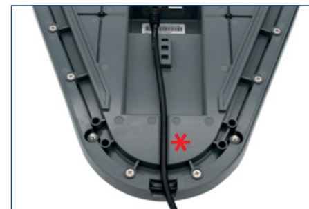
Bild 2: Achten Sie darauf, dass das Verbindungskabel korrekt angeschlossen ist und drücken Sie es zurück in die Kabelführungsrille*.
